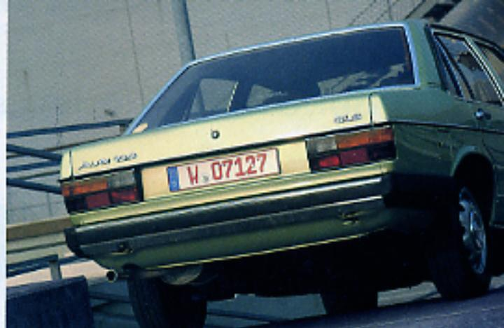
Klar gestaltete Heckpartie, versteckte Drucktasle zum Öffnen des Kofferraums
