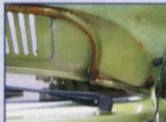
**Unter der Motorhaube:** Besonders an Verstärkungen gammelt es
