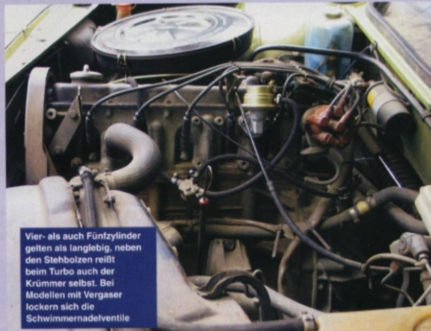
**Vier- als auch Fünfzylinder** gelten als langlebig, neben den Stehbolzen reißt beim Turbo auch der Krümmer selbst. Bei Modellen mit Vergaser lockern sich die Schwimmernadelventile
