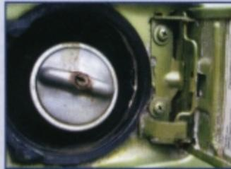
**Klappe auf:** Wie sieht's um den Einfüllstutzen herum aus?
