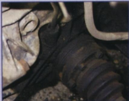
**Getriebe:** Lecks am Abtrieb kommen vor, für den Turbo sind die Antriebswellen zu schwach
