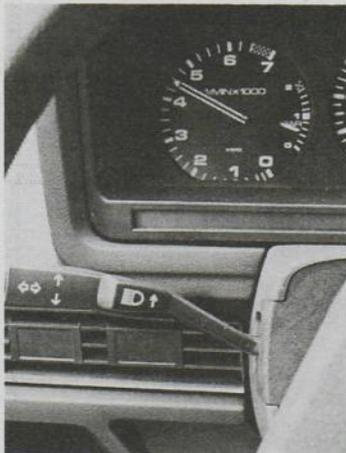
L'aiguille du compte-tours monte (4500 tr/min) mais celle du manomètre de pression de turbocompression reste en dessous de la valeur de repos.
