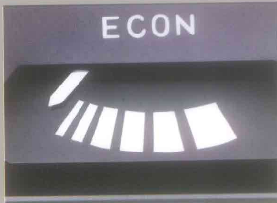
エコノマイザーメーター(インテークマニホールド内の負圧を計り、経済運転を指示します。)
