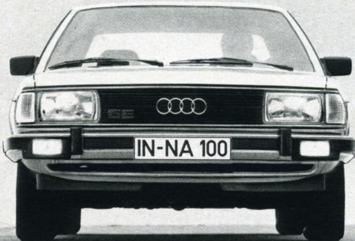
Überraschend kommt die Vorstellung des Audi 200 keineswegs, schon geraume Zeit war die Existenz eines serienreifen Turbo-Motors in Ingolstadt ein offenes Geheimnis. Nun läuft er also. Mit fünf Zylindern, einem Hubraum von 2,2 Liter und einem lange erprobten Leistungsdruckerzeuger von KKK.
