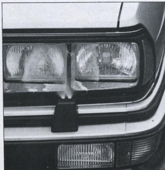
Zusammen mit der Windschutzscheibe werden bei eingeschaltetem Licht auch die Hauptscheinwerfer gereinigt. Der Strahl ist stark, Wischer sind überflüssig
