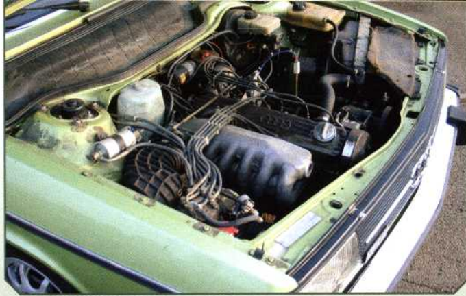
2,2-Liter-Fünfzylinder (MKB WC) mit Bosch-K-Jetronic
