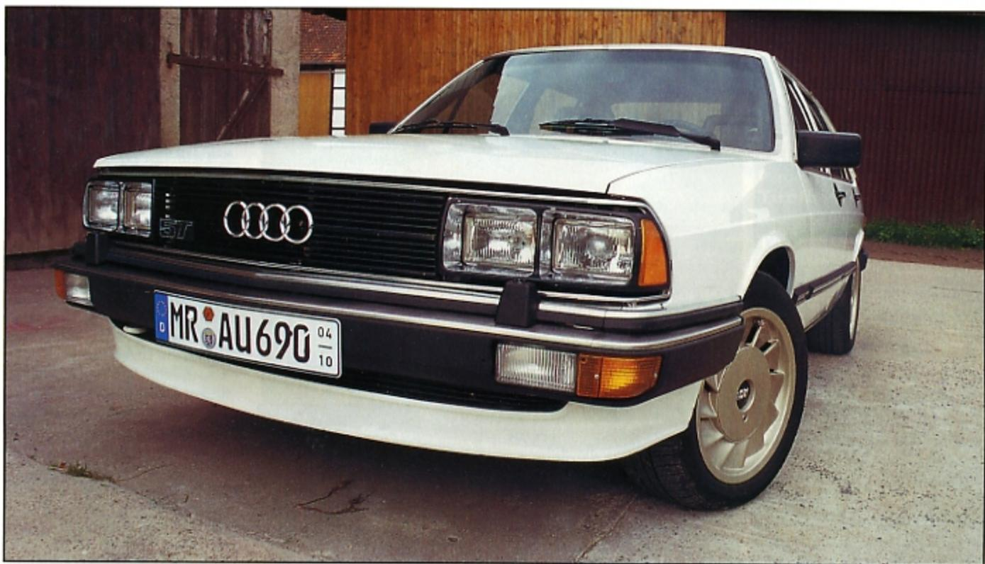
Die rechteckigen Doppelscheinwerfer, der Frontspoiler und die geänderten Stoßstangen unterscheiden den Audi 200 vom 100er
