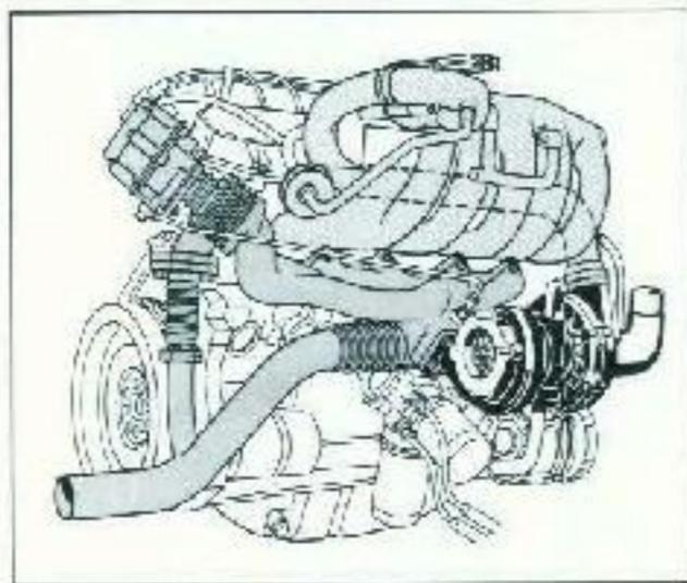
die Leistung des Fünfzylinder-Einspritzmotors auf beachtliche 125 kW steigert (170 PS nach DIN). Mit diesem Motor ist der Audi 200 der stärkste Europäer, der die Vorteile des Frontantriebs besitzt.
